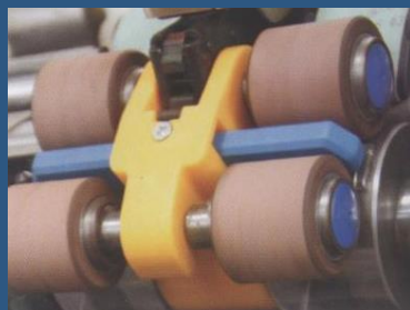
窄槽式空心罗拉紧密纺装置
