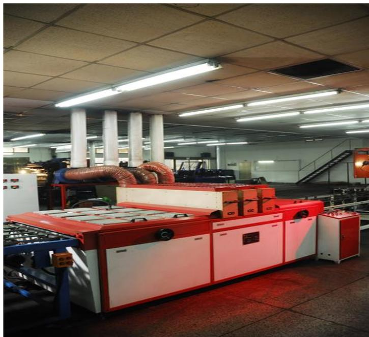
金属印刷智能 UV 光固化系统
