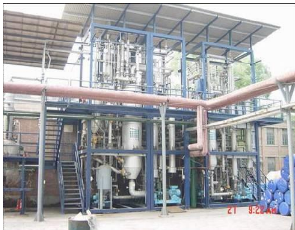
\alpha -长链烷基甜菜碱 1000L 环路生产装置
